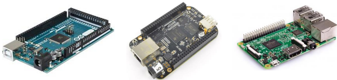
Figura 02 – Placas-mãe tecnologias Arduino, Beaglebone e Raspberry aplicadas em sistemas de controle e automação.
