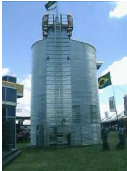
Figura 2 – Secador tipo cascata equipado com circuito de reaproveitamento de ar.
