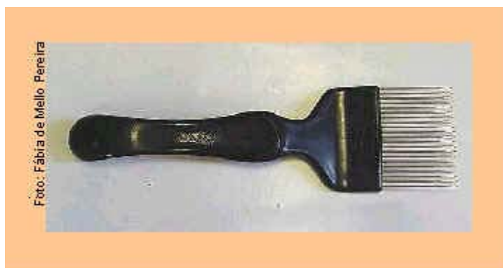
Figura 7. Garfo desoperculador ( www.cpamn.embrapa.br )
