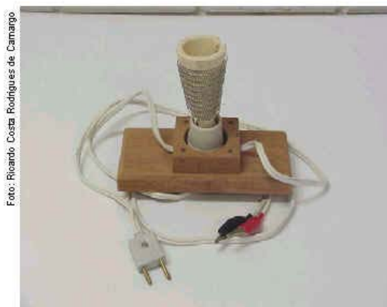
Figura 5 - Incrustador elétrico de cera ( www.cpamn.embrapa.br )
